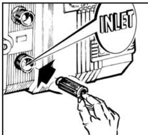
Træk filteret ud fra vandtilførselssamlingen
